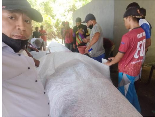
Gambar 6 Pelemuran Campuran Resin Dan Katalis Pada Mat 300
