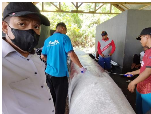
Gambar 8 Pelemuran Campuran Resin Dan Katalis Pada Mat 450
